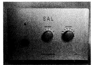
【写真6】入力セレクトと音量ボリュームを配置したシンプルな前面パネル
