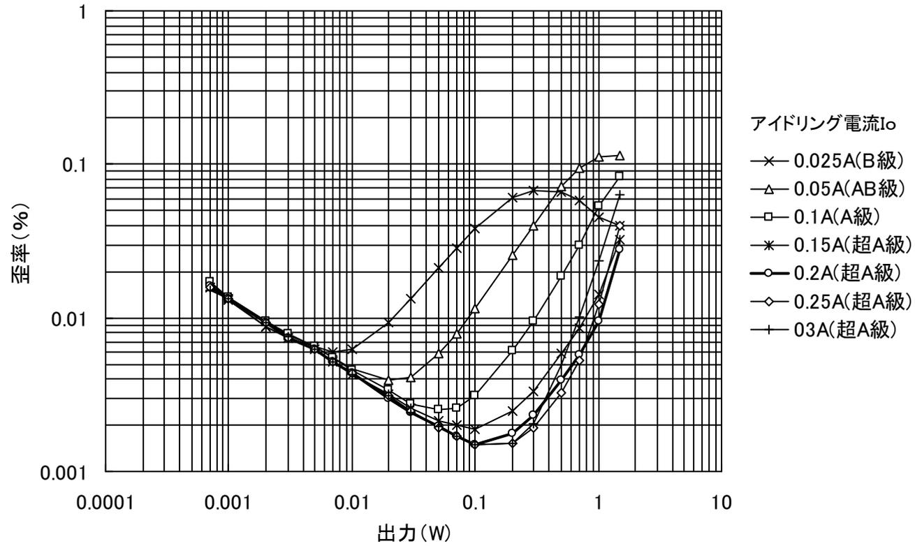
アイドリング電流 $I_o$ と歪率変化
