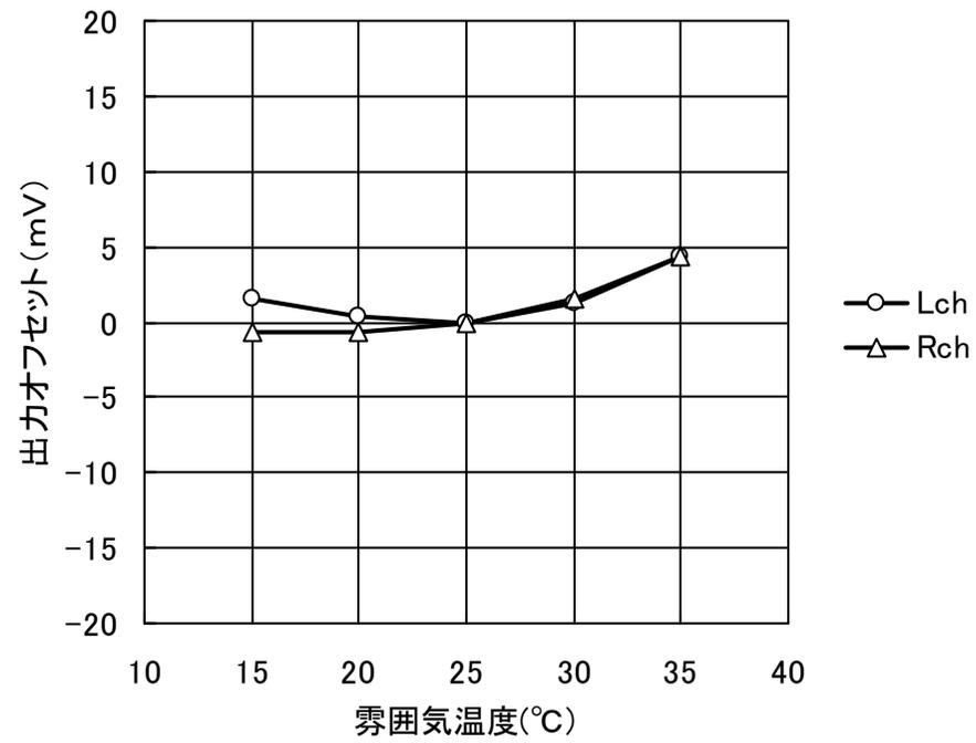
霧囲気温度と出力オフセット変化測定例
