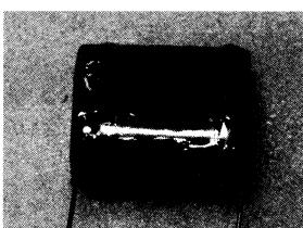
[写真3] 出力コンデンサーはシールドしてエポキシ樹脂を塗布
