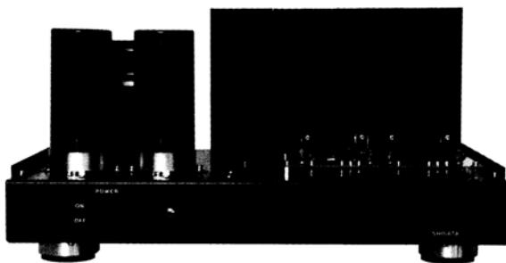
前号ハイブリッドプリアンプの高出力電圧の特徴を念頭に置いた、電圧ゲイン0dBのパワーアンプを製作。入力はコンプリメンタリーMOS-FETのソースフォロワーで、プリアンプの真空管出力段をハイインピーダンスで受けている。出力段はダーリントン接続で、出力パワートランジスターを2個並列接続して、A級動作で約30Wの出力を得ている。歪率は0.1%強で、周波数特性はDC～330kHzと広帯域。出力DCオフセットも良好。すっきりした音質で、期待どおりの音となった。
