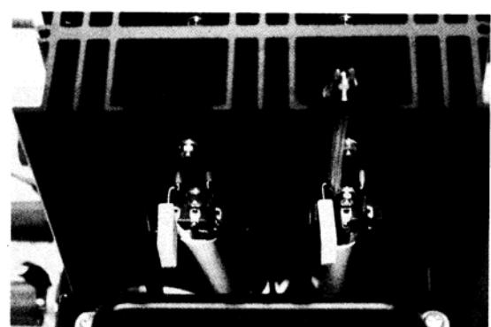
立てラグ板を取り付け、温度補償ダイオード STV-4H を配線する。リード線には、絶縁チューブを被せる
