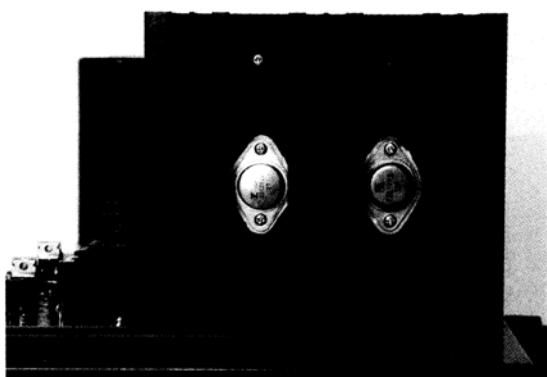
放熱器に取り付けたパワートランジスター 2SC2522 と 2SA1072。絶縁シートを挟み、シリコーングリスを塗布しておく
