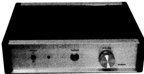
A級パワーアンプにおいて、アイドリング電流を増すと歪率が低下することは旧来から経験する。しかし、アイドリング電流を大きくすると、消費電力が増大する。最大出力の小さいヘッドフォンアンプでは問題ないレベルなので、まず「超A級」を容易に実現できるヘッドフォンアンプを製作した。出力段は0dBアンプで、前段にプリアンプ部を設け、リレーによる切り換えで適宜プリアンプをバイパス可能。無帰還アンプであるがクリアな音質傾向で、ヘッドフォンでの試聴が楽しくなる。
