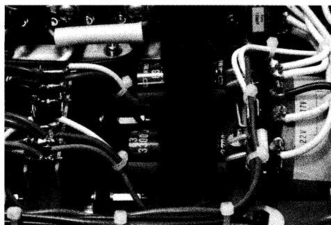
[写真11] 土B<sub>1</sub>電源はラグ板に組み上げ、平滑用電解コンデンサーはぐらつくのでゴムスポンジを介して接着
