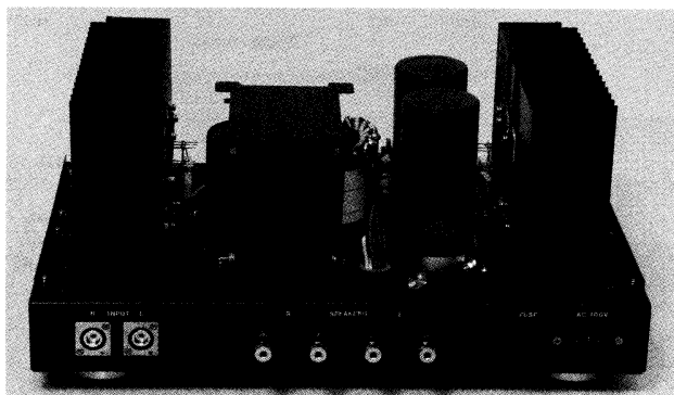
ケースカバーを外した内部のようす。中央に電源トランス、電解コンデンサー、左右に出力段Trを取り付けた大型放熱器を配置。背面には、左より入力端子、出力端子、ヒューズホルダー、ACインレット
