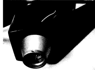
(e) マイクホルダー内にマイク基板を接着剤で固定する
